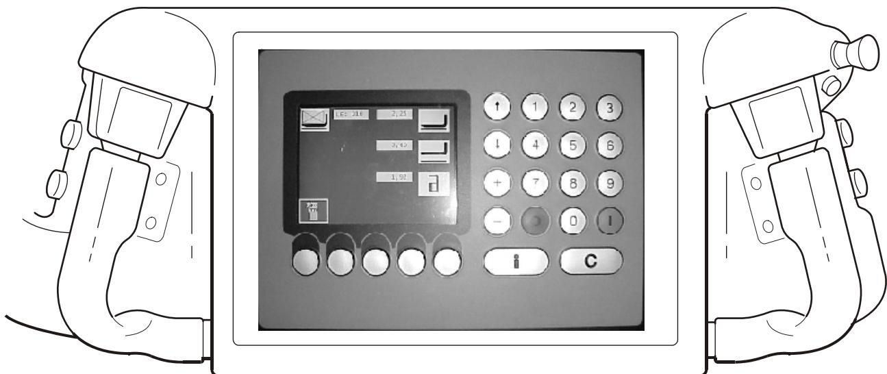
Программирование нужного уровня для погрузки и разгрузки является очень простой операцией при использовании клавиатуры панели ICP и функции "обучения" для преселектора высоты. Просто переместите вилы/кабину оператора на желаемую высоту и подтвердите уровень и высоту.
