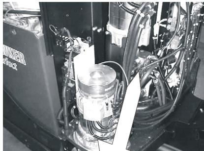
В случае возникновения неисправности, препятствующей опусканию кабины оператора с помощью рабочих органов управления, кабину можно опустить с помощью клапана аварийного опускания. Этот клапан расположен в блоке гидравлического оборудования на правой стороне штабелера.
