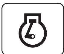
(1) Эта лампа загорается при работе системы автозамедления или включении кнопки замедления вращения двигателя на левом рычаге управления.
