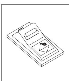
(1) Этот выключатель служит для того, чтобы зацепить или отцепить подвижный крюк быстрого фиксатора.
