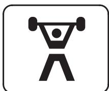
(1) Эта лампа загорается при нажатии выключателя форсировки на левом рычаге управления.
