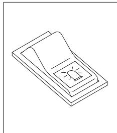
(1) При нажатии на этот выключатель включается вращающийся проблесковый маяк на кабине.
