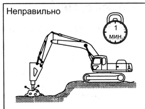
**6) ПРИ НАНЕСЕНИИ УДАРОВ ГИДРОМОЛОТОМ НЕ ПЕРЕМЕЩАЙТЕ МАШИНУ ИЛИ САМ ГИДРОМОЛОТ**
