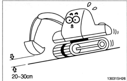
Опасны повороты машины при езде по склону.
