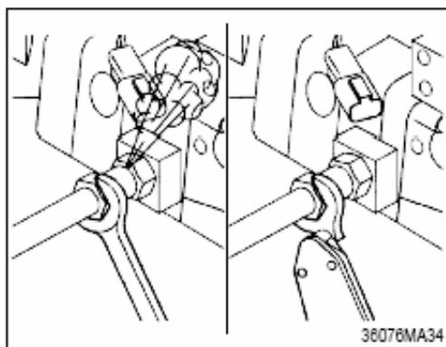
③ Места выхода воздуха в трубопроводах из насоса давления в топливный насос могут быть локализованы путем работы насосом давления или кнопкой переключателя для создания давления в топливной системе. Проверьте все трубы, соединения и топливный фильтр на отсутствие внешних утечек топлива.
