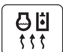
(1) Эта лампа загорается при температуре охлаждающей жидкости ниже 30°C.
