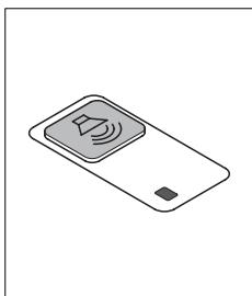
(1) Этот выключатель используется для подачи сигнала окружающим о начале движения машины вперед или назад.
