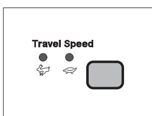
① Этот переключатель контролирует скорость движения. Выбирая высокую скорость (символ «Кролик») – нажать переключатель один раз, выбирая низкую скорость (символ «Черепаха») – нажать еще раз.
