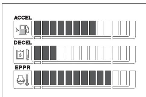
② Для изменения высоких оборотов двигателя нажмите одновременно переключатель режимов пользователя (USER Mode) и выбор (Select). После этого индикатор ACCEL (Ускорение) мигает с интервалами 0,5 сек.
