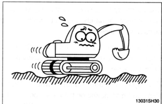
При работах на мягких грунтах помещайте настилы или деревянные панели под гусеницы для предотвращения увязания экскаватора.
