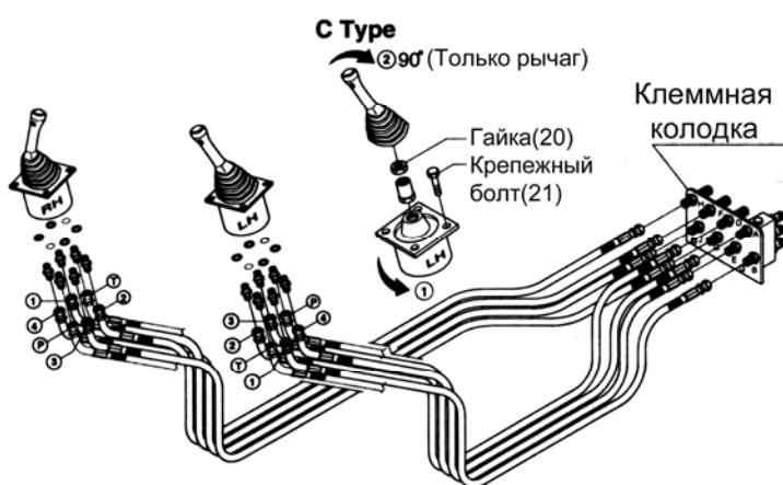
\* Каждый раз, когда в данной схеме управления машиной происходят изменения, производите такие же изменения на табличке схемы управления в кабине. Схема на табличке ОБЯЗАТЕЛЬНО должна совпадать с настоящей схемой управления машиной.
