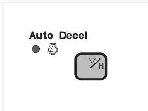
① Он используется для включения функции автозамедления. При этом скорость двигателя автоматически снижается при нахождении всех рычагов и педалей в нейтральной позиции и происходит экономия топлива.
