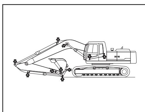
\* Если они установлены неправильно, будет иметь место быстрый износ пальцев и втулок, а также повышенный шум и вибрации при работе экскаватора.
