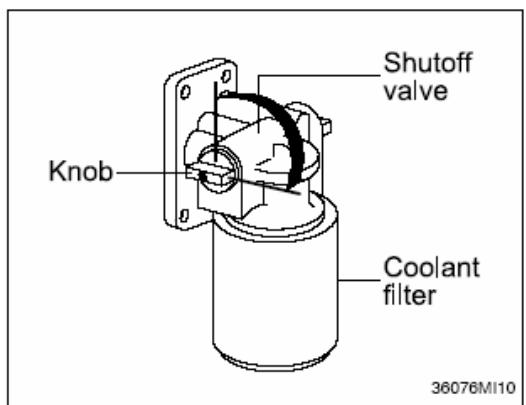
(3) Нанесите тонкий слой смазочного масла на поверхность прокладки перед установкой нового фильтра охладительной системы.
