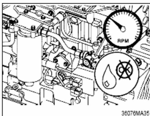
④ Открытая форсунка также может втянуть рабочий газ назад в насос, и в сливной трубе появится воздух.
