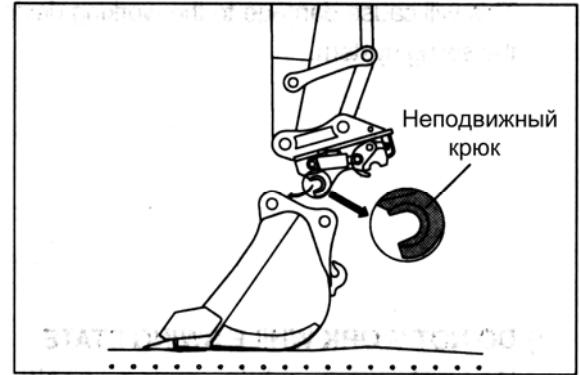
(4) Джойстиком управления поместите ковш в положение «внутрь», т. е. по направлению к экскаватору. Тем самым Вы фиксируете подвижный крюк на соединительном стержне ковша. Проверьте, надежно ли фиксированы подвижный крюк и соединительный стержень ковша.
