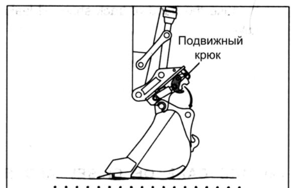
(5) Заблокируйте выключатель быстрого фиксатора. Джойстиком управления поместите ковш в положение «внутрь», т. е. по направлению к экскаватору.
