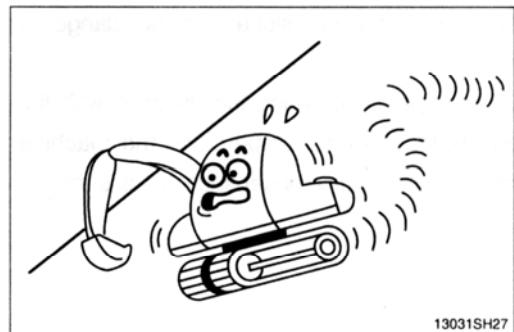
Предел угла наклона двигателя составляет  $35^{\circ}$ .
