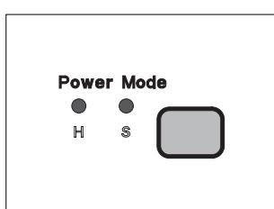
① При нажатии на этот переключатель (
