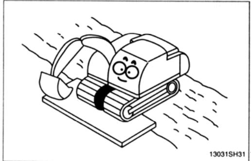
При работе в воде или при переезде мелких водоемов проверьте состояние грунта на дне, глубину и скорость течения воды, а затем следите, чтобы уровень воды не превышал высоты несущего катка.
