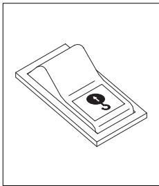
(1) При нажатии данного выключателя зуммер издает звуковой сигнал и загорается контрольная лампа перегрузки в том случае, если машина перегружена.
