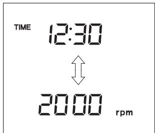
(1) Этот индикатор показывает текущее время и информацию о машине: скорость вращения двигателя, температуру охлаждающей и гидравлической жидкостей, давление гидравлической жидкости в двигателе, а также коды неисправностей.
