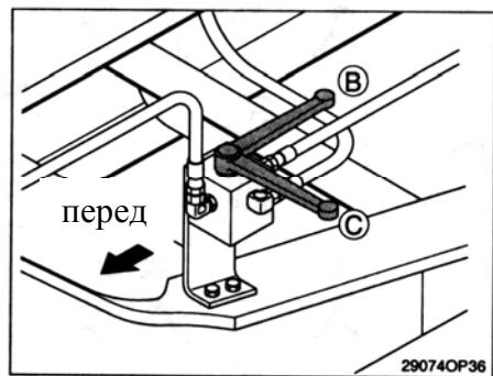
**(2) Двухнаправленный поток** (работа грейферным ковшом или вертикальный вруб ковша).
