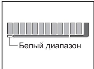
(1) Этот индикатор показывает количество топлива в топливном баке.
