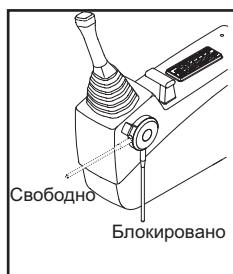
(1) При установке рычага в положение «БЛОКИРОВАНО» все педали и рычаги управления блокированы.
