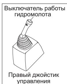
(1) При нажатии этой кнопки гидромолот работает, только если на панели переключателей включена кнопка выбора работы гидромолота.
