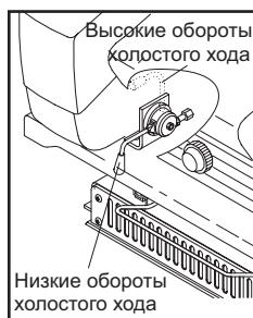
(1) Этот рычаг используется для увеличения или уменьшения частоты вращения двигателя при неисправностях контроллера центрального процессора управления (ЦПУ). Соедините аварийный резистор с разъемом CN-19. См. стр. 3-30.
