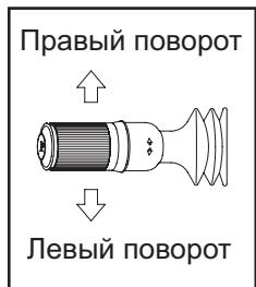
① Указатель сигнализирует другим машинам или оборудованию о повороте экскаватора.
