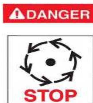
Рис. 47. Знак «Не прикасайся к подвижным частям машины до их полной остановки»
