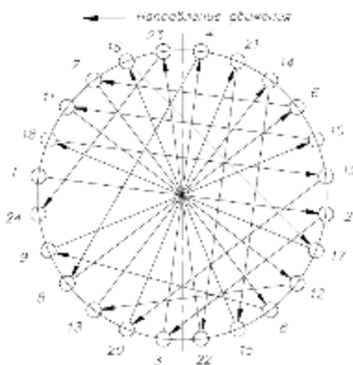
Рис.46. Порядок затяжки болтов и гаек ОПУ экскаватора ЭО-3223
