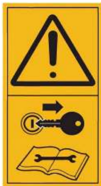
Рис.52. Знак «Общие требования безопасности. Заглуши двигатель и вынь ключ зажигания перед работами по техническому обслуживанию или ремонту»
