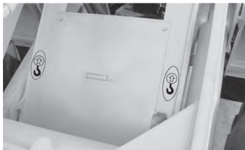
Рисунок 1.7 — Расположение знаков «Место строповки» на передней полураме
