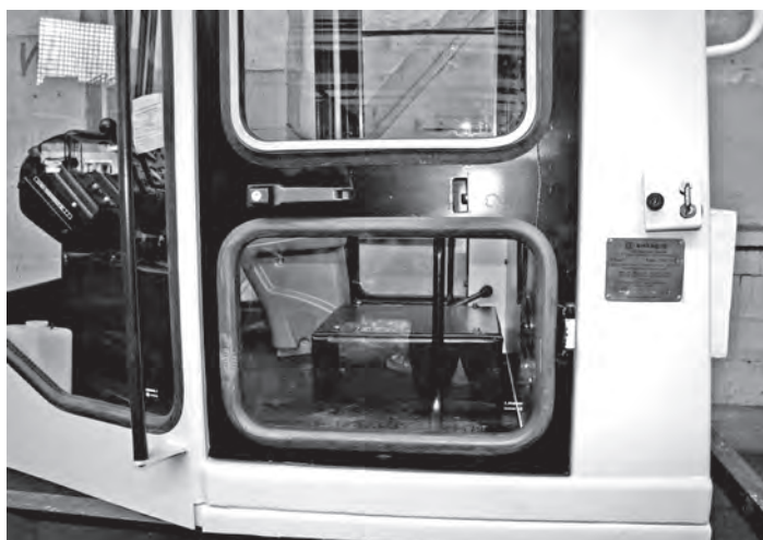
Рисунок 1.8 — Расположение маркировочной таблички кабины
