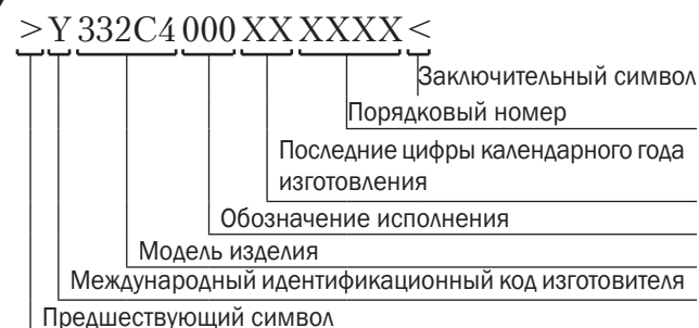
Рисунок 1.5 — Маркировочная табличка и её расшифровка:
